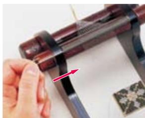
両方のスプリングに、ストッパーをゆっくりと差し込みます。この時、ストッパーがタテ糸の上を通るように気を付けましょう。
